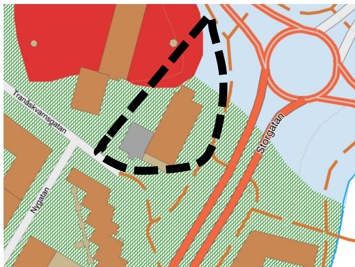
Figur 6. Utdrag ur SGU:s jordartskarta. Planområdet utgörs främst av isälvsediment med fyllning
