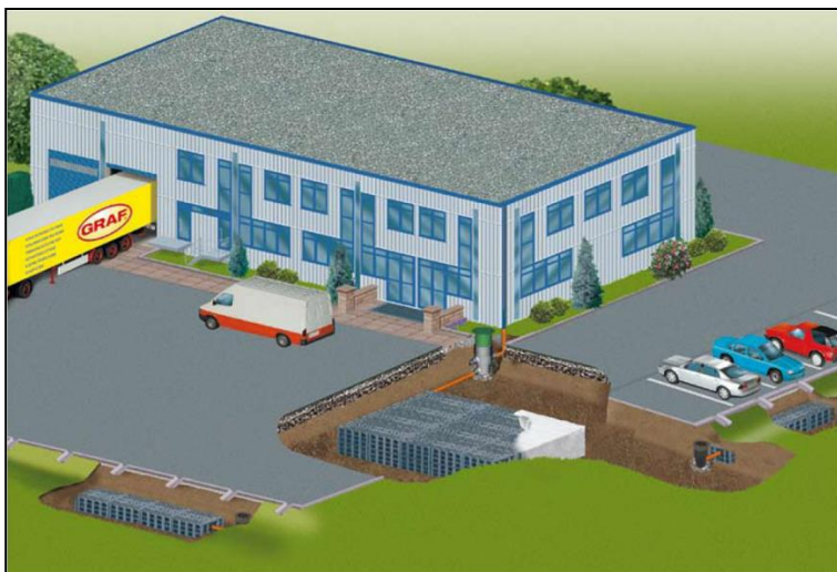
Figur 16. Exempel på utjämningsmagasin bestående av dagvattenkassetter (Uponor, 2009)
